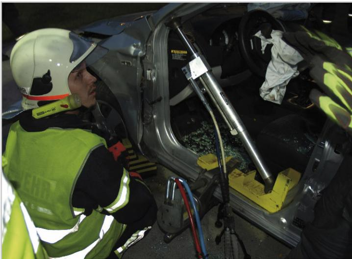
Arbeiten mit dem hydraulischen Rettungszyylinder
