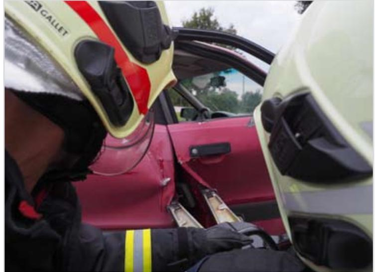
Arbeiten mit dem hydraulischen Rettungsgerät
